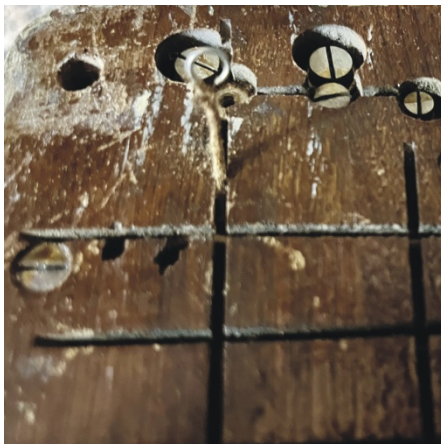
LM Ericsson tipo AB 110: hilos de la circuitería eléctrica, por las distintas hendiduras en la trasera del teléfono.
