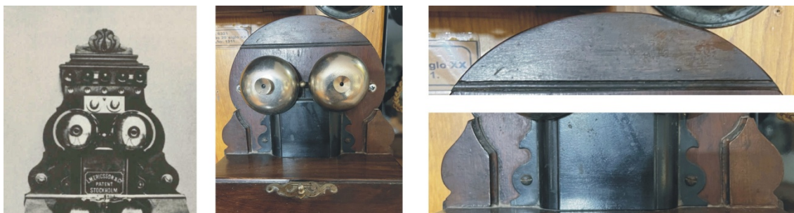
Detalles de la reforma llevada a cabo en la parte superior del teléfono LM Ericsson tipo AB 165
