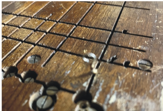
LM Ericsson tipo AB 110: hilos de la circuitería eléctrica, por las distintas hendiduras en la trasera del teléfono.
